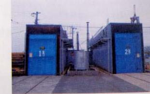
高温型蒸気式乾燥機(熱硬化の最大温度130℃)で薬剤を熱硬化させ、数日間の養生の後、完成
