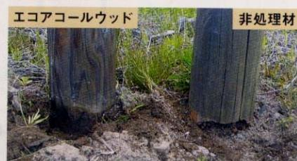
実験開始後14年を経過したエコアコールウッドと未処理材。エコアコールウッドには発生していない、腐朽や割れが未処理材には激しく見られる。
