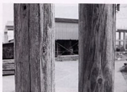
写真5 自社製外暴露試験材の表面（地盤から1.5m高）の比較 左:素材、右:エコアコルウッド
