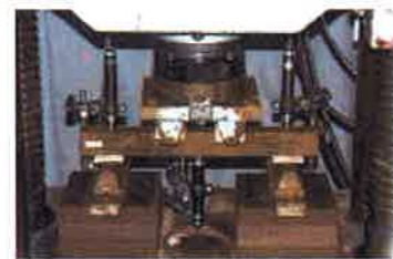
写真3 曲げ載荷状況
