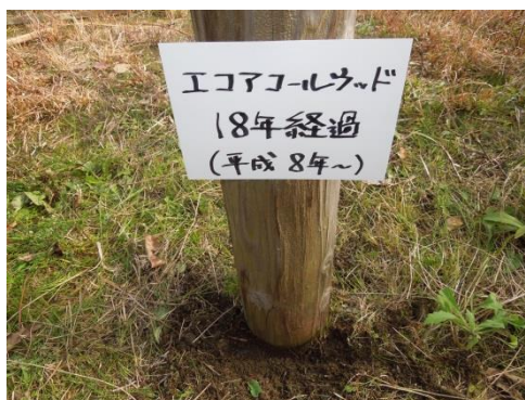
写真3 18年経過後のエコアコールウッドの曝露試験状況
