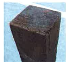
写真5 海水中 2 年目の PF 試験体 端部
