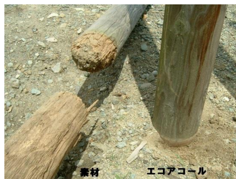
写真1 10年経過後のエコアコールウッドと素材の曝露試験状況
