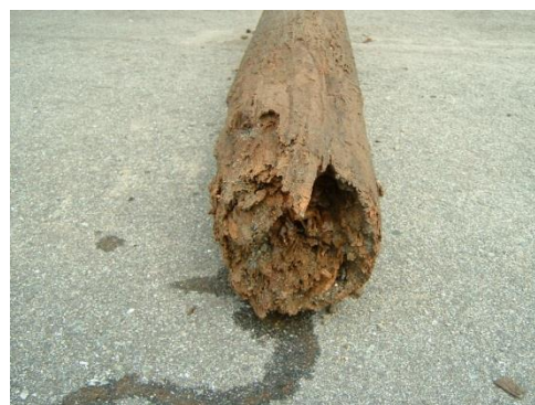
写真2 10年経過後の素材地際断面
